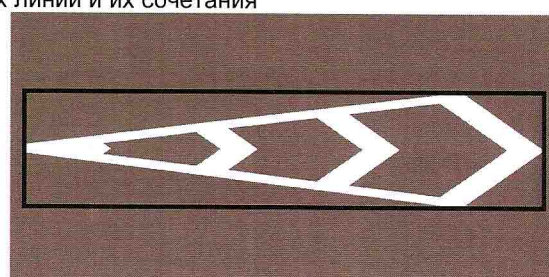
Рисунок 6 – Схема расположения границ горизонтальной разметки в виде сплошных и прерывистых одиночных линий и их сочетания
